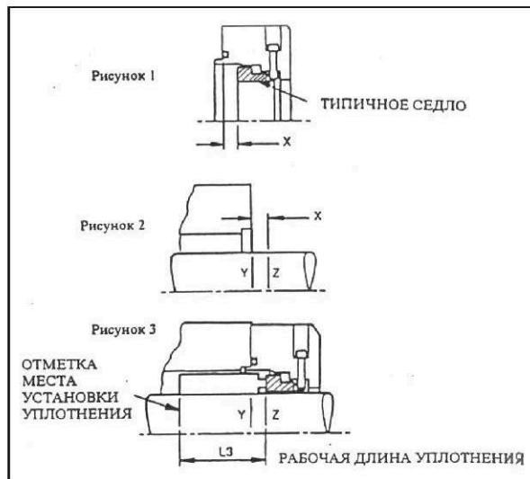
4. Для соответствующей конструкции определить размер "Х" от передней поверхности крышки уплотнения до рабочей поверхности седла (рис. 1).
